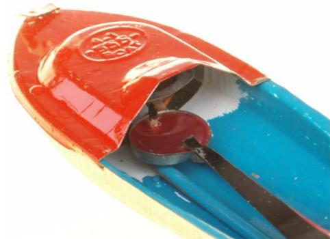
Deck, dass die Metallplatte in die die Rohrenden münden gerade über der Kerzenflamme ist. Nach einem Moment beginnt das Boot langsam und ruckartig zu fahren. Nach kurzer Zeit fährt es gleichmässig tuckernd durch den „See“.
