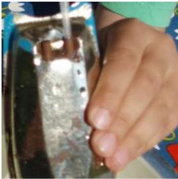
Mit der Pipette wird zunächst Wasser in eine der beiden Rohröffnungen am Heck (hinteres Ende) des Bootes gefüllt, bis es durch die andere Rohröffnung herausfließt. Dann setzt man das Boot langsam ins Wasser, so dass es innen trocken bleibt und die Rohröffnungen unter Wasser sind. Nun zünden Sie die Kerze an. Die Kerze schieben Sie so unter das
